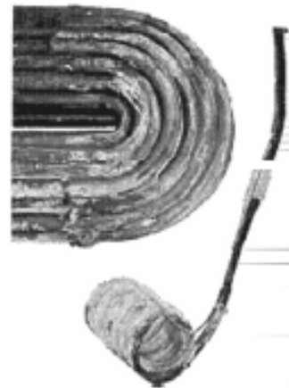
Verkalkung auf Heizschleifen
